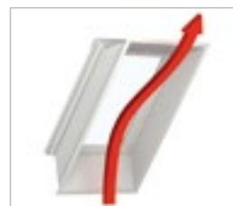
Circulation idéale de l'air chaud qui aide à éliminer la condensation. La forme de l'habillage permet une isolation supplémentaire. Aide à éviter les nœuds de construction.
